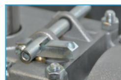
MOGELIJKHEID VOOR AANSLUITEN ONTGRENDELINGSKABEL POSSIBILITÉ D'UTILISER LE DÉBLOCAGE PAR CÂBLE
